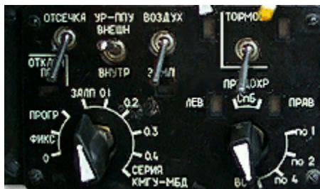
Figura 19: Painel de Controle do Sistema de Armas do SU-25T
