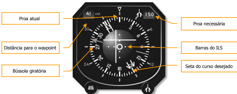
Figura 11: Indicador Situação Horizontal (HSI)
