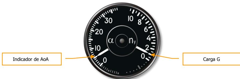
Figura 9: Indicador AOA e Acelerômetro
