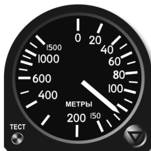
Figura 13: Radar Altímetro
